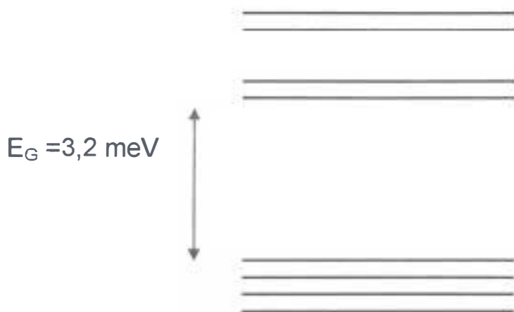
Slika 6.11. Degenerirani nivoi u kristalu Yb_xY_{1-x}InCu_4 shematski su prikazani bliskim nivoima. Kada stavimo ion iterbija u kristal Yb_xY_{1-x}InCu_4 , koji ima kubičnu simetriju, osam degeneriranih nivoa se rascijepi na 4 + 2 + 2 nivoa tj. na kvartet i dva dubleta.
