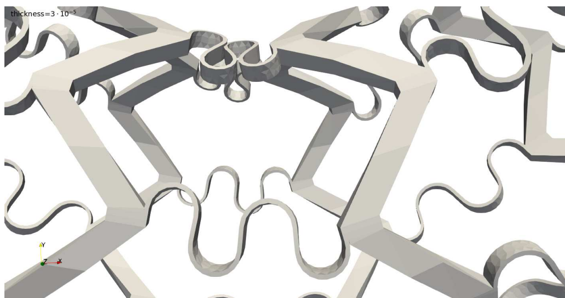
Slika 4.49: Uvećani dio oko polovine deformiranog stenta po x-osi za thickness = 3 \cdot 10^{-5}
