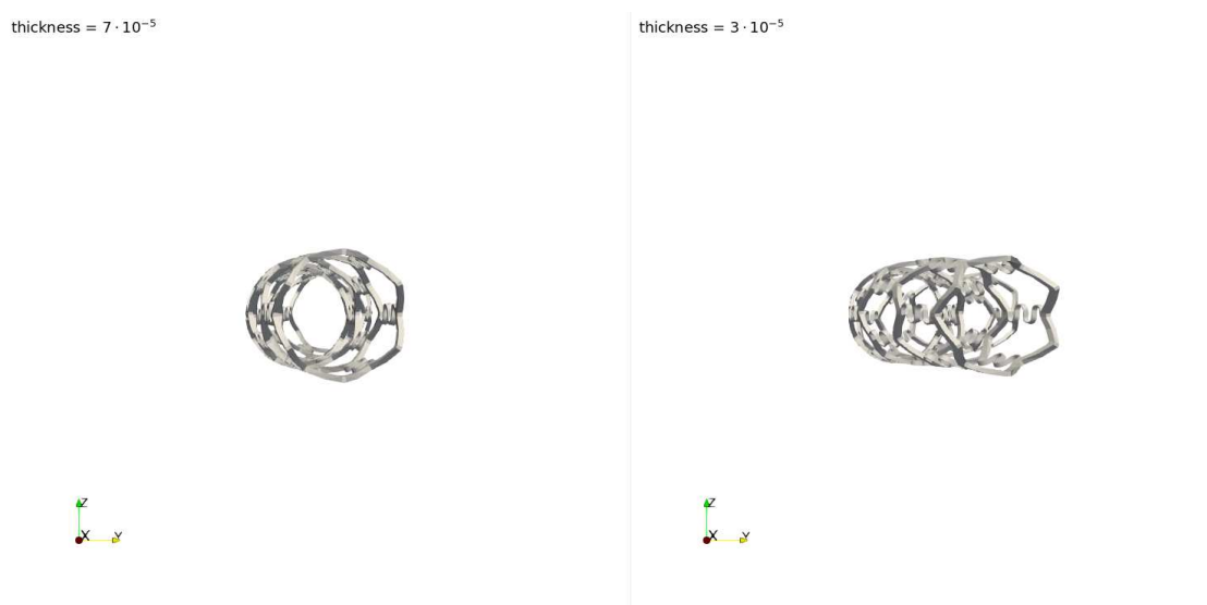
Slika 4.38: Deformirani stentovi u yz-ravnini
