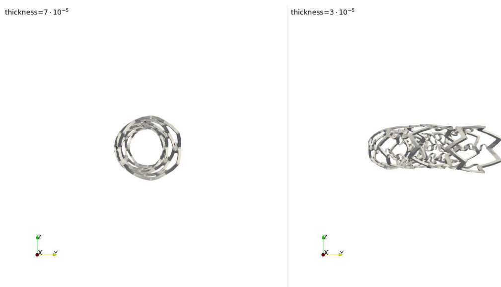
Slika 4.51: Deformirani stentovi u yz-ravnini
