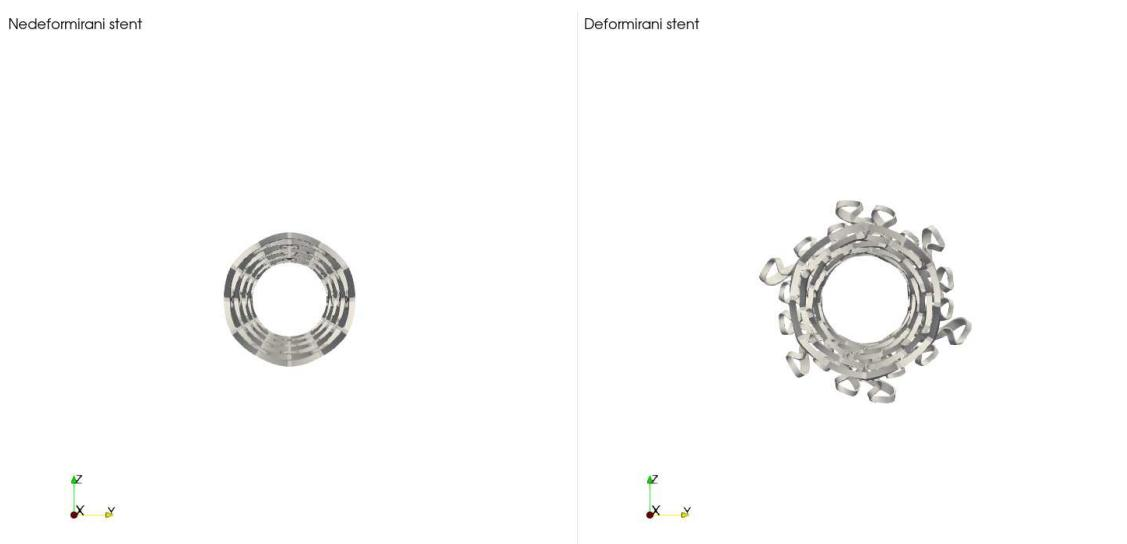
Slika 4.7: Usporedba deformiranog i nedeformiranog stenta u yz-ravnini, sila tlaka povećana 5 puta
