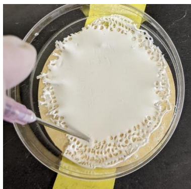
Slika 21. Prikaz nanošenja C18 materijala ( C18 Solid Phase Extraction Disks, Empore ) na vrh plastičnog nastavka za pipetu (engl. stage tip ). A) Šupljom iglom utisne se dvaput u C18 materijal koji zaostaje unutar igle i zatim B) se nanese na vrh plastičnog nastavka za pipetu od 2-200 \mu\text{L} .
