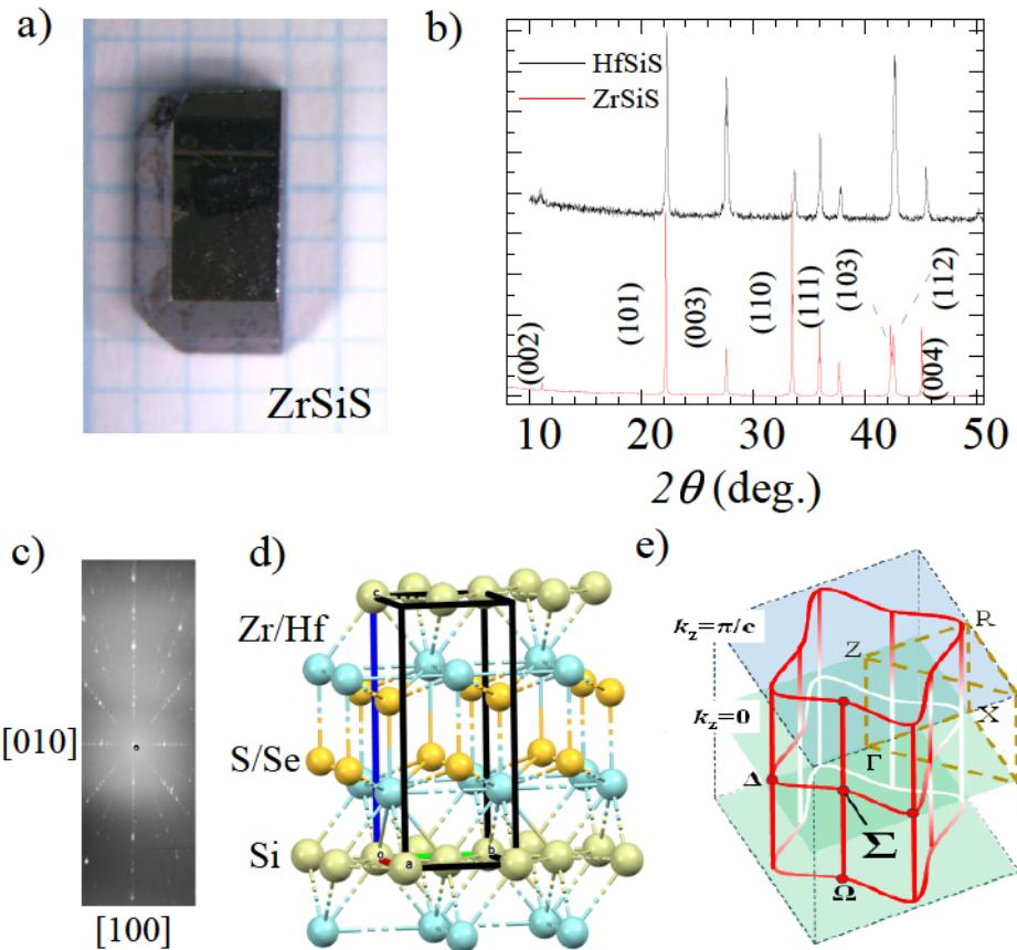
Slika 3.1: a) Monokristal ZrSiS-a dobiven CVT metodom. b) Difrakcija rendgenskih zraka na prahu dobivenih ZrSiS i HfSiS kristala pokazuje da se radi o izostrukturalnim sustavima. c) Laue difrakcija rendgenskih zraka potvrđuje kvalitetu monokristala. d) Struktura XSiY ( $X = Zr, Hf$ ;  $Y = S, Se, Te$ ) sustava. e) Kavez nodalnih linija u Brillouinovoj zoni ZrSiS-a.
