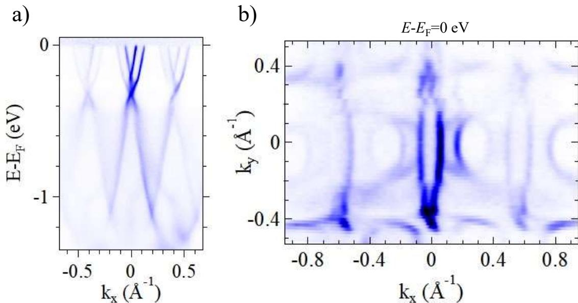
Slika 4.9: Slika prikazuje Diracove stošce u ARPES-u na uzorku TaNiTe<sub>5</sub>. Disperzija vrpcu i mapiranje Fermijeve plohe je napravljeni pri energiji od 33 eV. Uzorci su kalani duž *ac* ravnine neposredno prije mjerena u ultra-visokom vakuumu.
