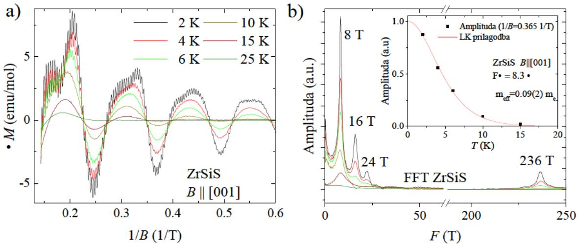
Slika 3.3: a) De Haas-van Alphen oscilacije u monokristalu ZrSiS-a za magnetsko polje usmjereni duž  $z$  kristalne osi. b) Fourierov transformat prikazuje frekvencije 8 T s izraženim harmonicima pri 16 T i 24 T te frekvenciju od 236 T. Efektivna masa nosioca naboja iznosi  $m_{eff} = 0.09(2)m_e$  (umetak).
