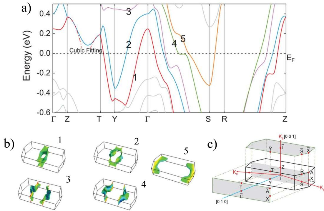
Slika 4.6: a) Izračunate vrpce između točaka visoke simetrije. Zanimljivo je primjetiti da postoji niz paralelnih vrpci koje bi mogle dati snažan optički odgovor. b) Elementi Fermijeve plohe koji odgovaraju označenim vrpccima. c) Brillouinova zona s označenim točkama visoke simetrije. Preuzeto iz Ref. [28].
