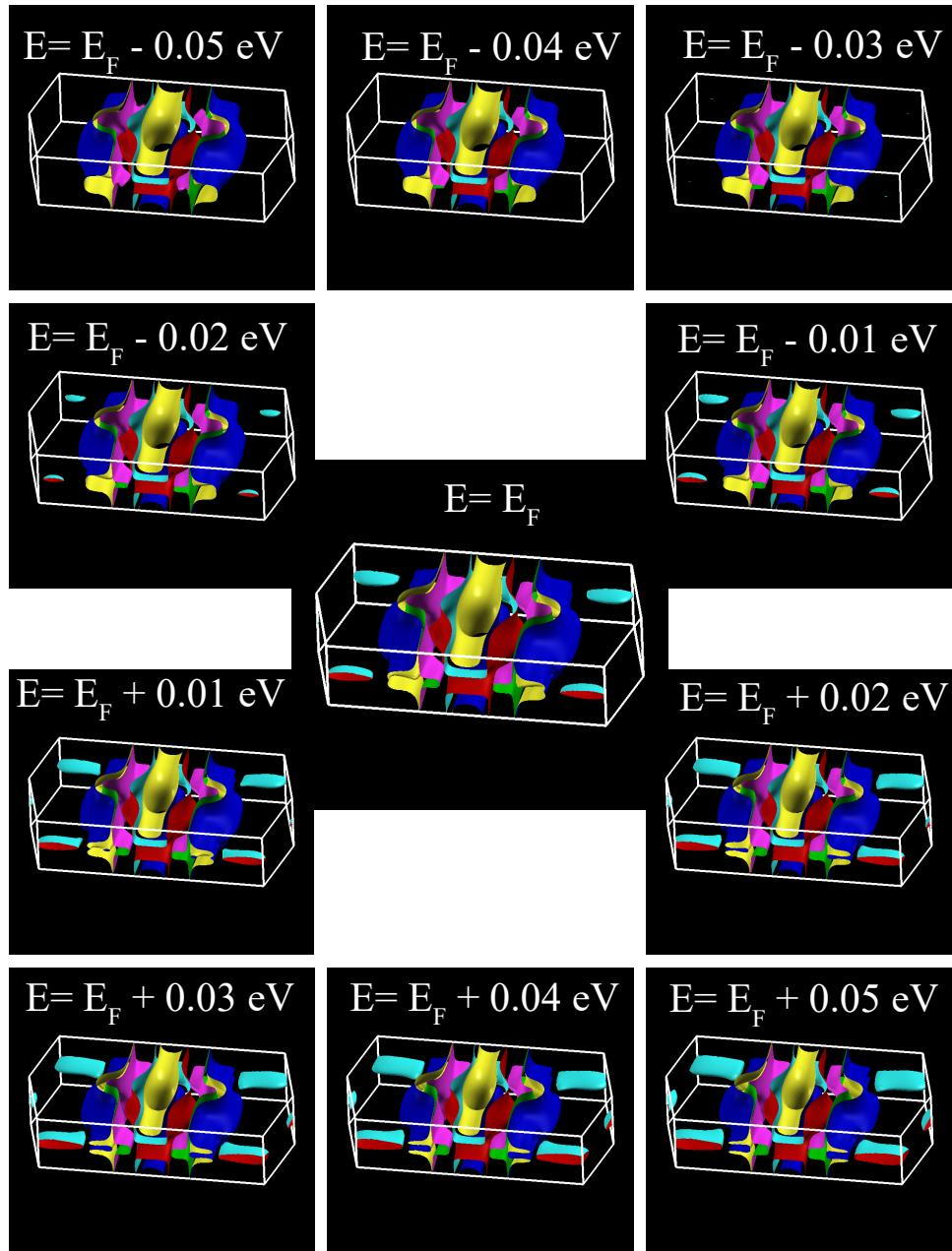
Slika 4.5: Izračunate plohe konstantne energije bliske Fermijevoj razini. Pri energiji  $E = E_F - 0.05$  eV se čitava ploha sastoji od kvazi-2D elemenata formiranih duž jedne osi. Pri energiji  $E = E_F - 0.02$  eV otvaraju se četiri nova džepa 3D naravi označena tirkiznom i crvenom bojom. Dodatni se džep (istih boja) pojavljuje pri energiji  $E = E_F - 0.02$  eV u kutu Brillouinove zone, također po naravi 3D.
