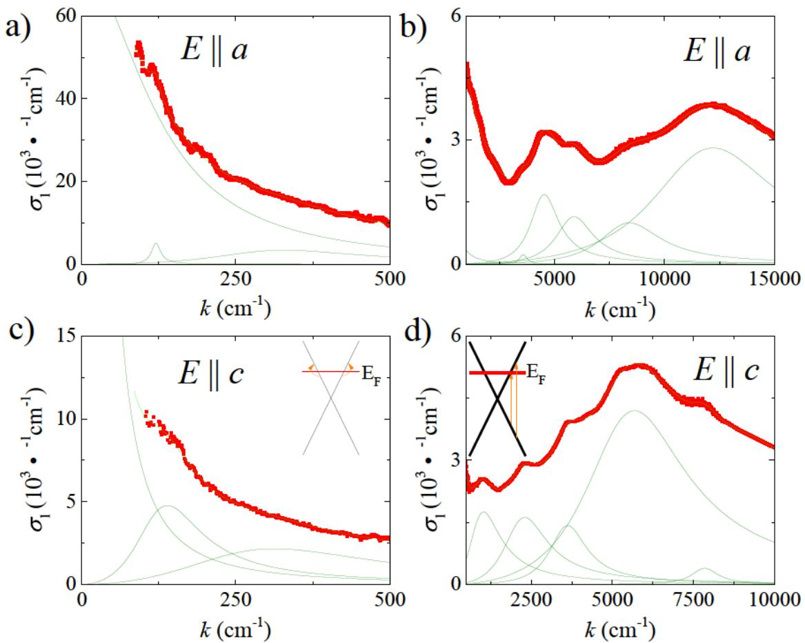
Slika 4.8: Prikaz prilagodbe Drude-Lorentz oscilatora na eksperimentalne podatke optičke vodljivosti. Slike a) i c) prikazuju samo Drude komponentu, dok slike b) i d) prikazuju Drude-Lorentz oscilatore za više energije koji opisuju među-vrpčane prijelaze. Umetci skiciraju unutarvrpčane i međuvrpčane prijelaze.
