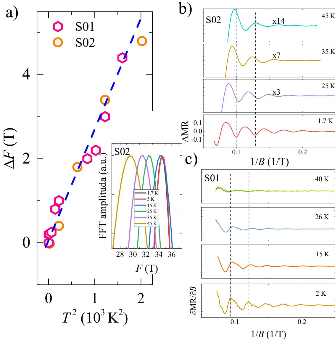
Slika 2.6: a) Kvadratna temperaturna ovisnost frekvencije Shubnikov-de Haas oscilacija u BST2S s nagibom  $2 \times 10^{-3} \text{ T/K}^2$  (plava isprekidana linija). Umetak prikazuje vrhove u Fourierovom transformatu izmjerjenih oscilacija. b), c) Shubnikov-de Haas oscilacije u uzorcima S01 i S02.
