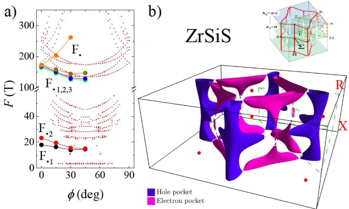
Slika 3.5: Usporedba eksperimentalno dobivenih frekvencija i DFT izračuna za razne  $\phi$  u ab-ravnini. Uočljivo je dobro slaganje za  $F_\delta$  i  $F_\epsilon$ , dok za  $F_\gamma_1$  i  $F_\gamma_2$  možemo prepoznati slaganje u trendu. b) Izračunati oblik Fermijeve plohe  $ZrSiS$ -a. Elektronski džepovi označeni su rozom bojom, dok su šupljinski plavi.
