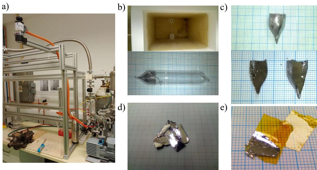
Slika 2.2: a) Postav za vakuumiranje i zataljivanje kvarcnih ampula. b) Kvarcna ampula u peći i nakon sinteze. c) Dobiveni monokristal BSTS2 d) Rezultat sinteze BST2S. e) Tanki uzorak odvojen *caption* trakom.
