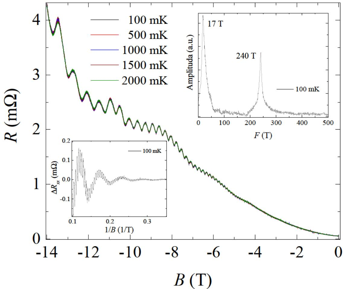
Slika 3.6: Slika prikazuje Shubnikov-de Haas oscilacije u magnetootporu monokristala HfSiS-a za magnetsko polje usmjereni duž [001] smjera i struju u [100] smjeru. Krivulje na mjerenim temperaturama od 100 mK do 2 K se preklapaju zbog male efektivne mase nosilaca naboja. Umetci prikazuju oscilacije pri 100 mK u ovisnosti o inverzu polja i odgovarajući FFT s kojeg se iščitavaju frekvencije od 17 T i 240 T. Nije uočen potpis magnetskog probaja.
