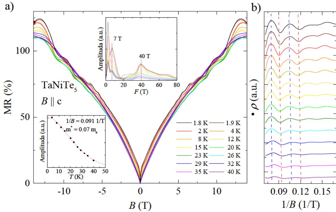
Slika 4.3: a) Magnetootpor uzorka TaNiTe<sub>5</sub> na brojnim temperaturama ispod 40 K do polja od 14 T paralelnog  $c$  osi. Magetoootpor je pozitivan te pri 14 T iznosi približno 120% na temperaturi od 1.8 K. Umetci prikazuju FFT izoliranih oscilacija s dvije izražene frekvencije, 7 T i 40 T te određenu efektivnu masu fermiona koji doprinosi frekvencijom 40 T u iznosu od  $m^*/m_e \approx 0.07$ . b) Izolirane Shubnikov-de Haas oscilacije.
