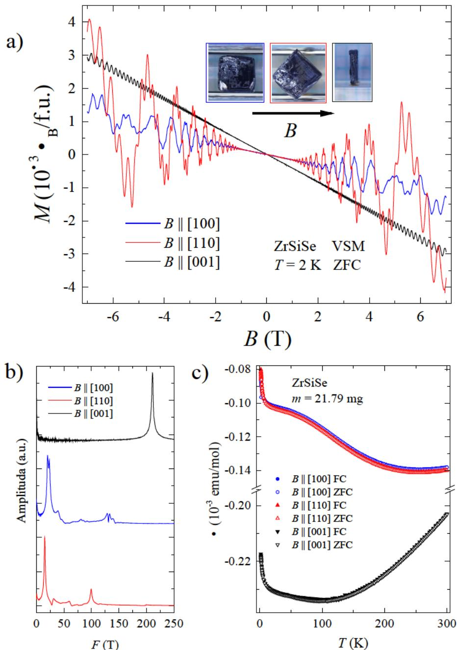
Slika 3.13: a) De Haas-van Alphen oscilacije pri 2 K za polja do 7 T. Vidljiva je značajna razlika u krivuljama za polje paralelno  $c$ -osi i  $ab$ -ravnini. b) Pripadajući Fourierov transformat. c) Temperaturna ovisnost magnetske susceptibilnosti za polje paralelno i okomito na  $c$ -osi.
