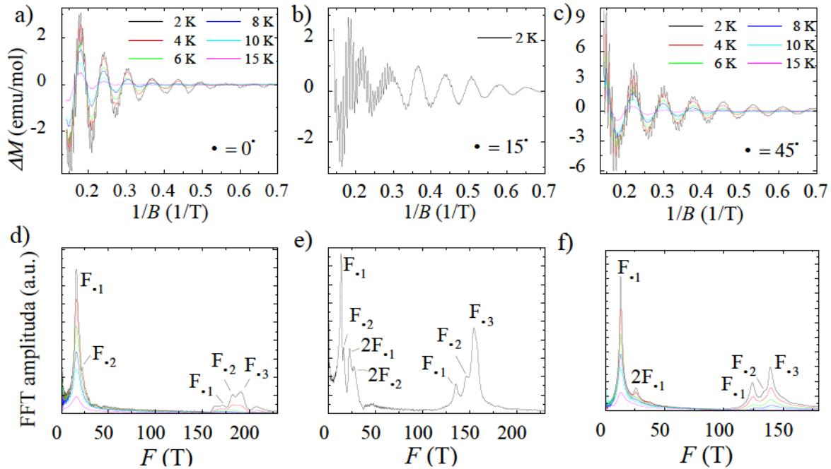
Slika 3.7: a)-c) Temperaturna ovisnost de Haas-van Alphen oscilacija u HfSiS-u za tri različita smjera magnetskog polja  $\phi$  u *ab*-ravnini. Oscilacije su izražene i vidljive od malih polja. d)-f) Odgovarajuće FFT slike. Primjećujemo dvije grupe frekvencija.
