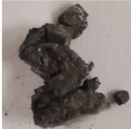
(b) Neobrađeni produkt sinteze \text{YbMnBi}_2 .
