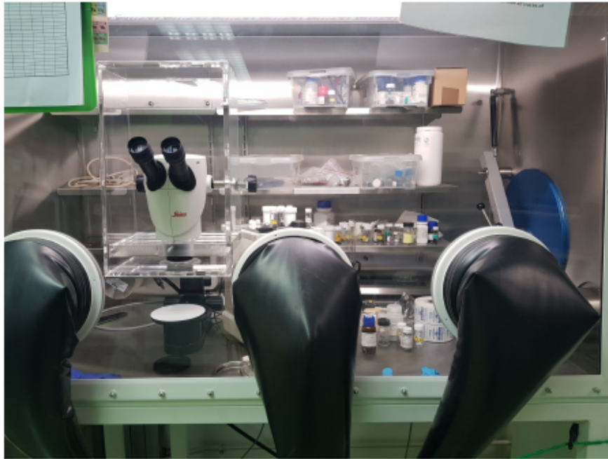
Slika 4.4: Slika gloveboxa izvana. Na slici su prikazane gumene rukavice, optički mikroskop i materijali korišteni za razne sinteze izvedene u laboratoriju.
