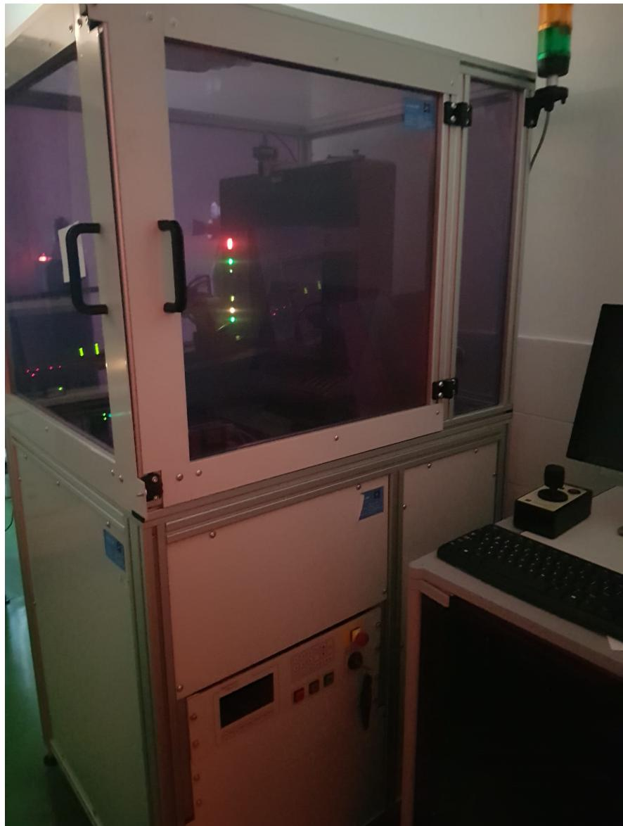
Slika 5.2: Eksperimentalni postav za mjerene Laueove difrakcije u laboratoriju za mikroskopiju, PMF, Zagreb.
