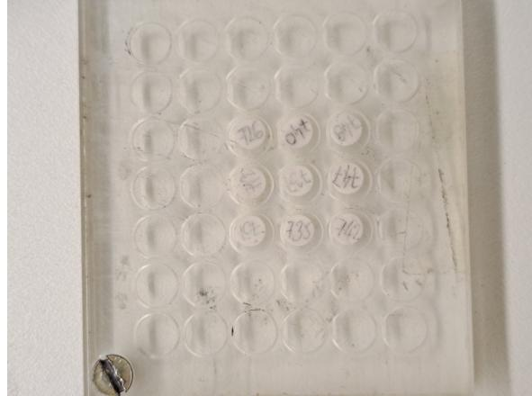
Slika 3.6: Dozimetri TLD-700 u držaču od pleksiglasa. Dimenzije držača su  $61\text{ mm} \times 54\text{ mm} \times 8\text{ mm}$ .
