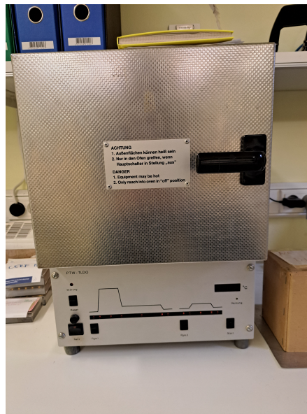
Slika 3.3: Peć za aniliranje i predgrijavanje dozimetara.
