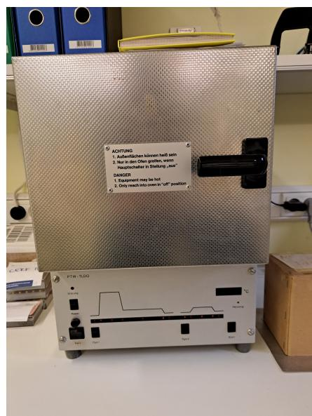
Slika 3.3: Peć za aniliranje i predgrijavanje dozimetara.
