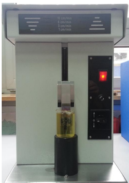
Slika 30. Nanošenje sola na podlogu od nehrđajućega čelika postupkom uranjanja.
