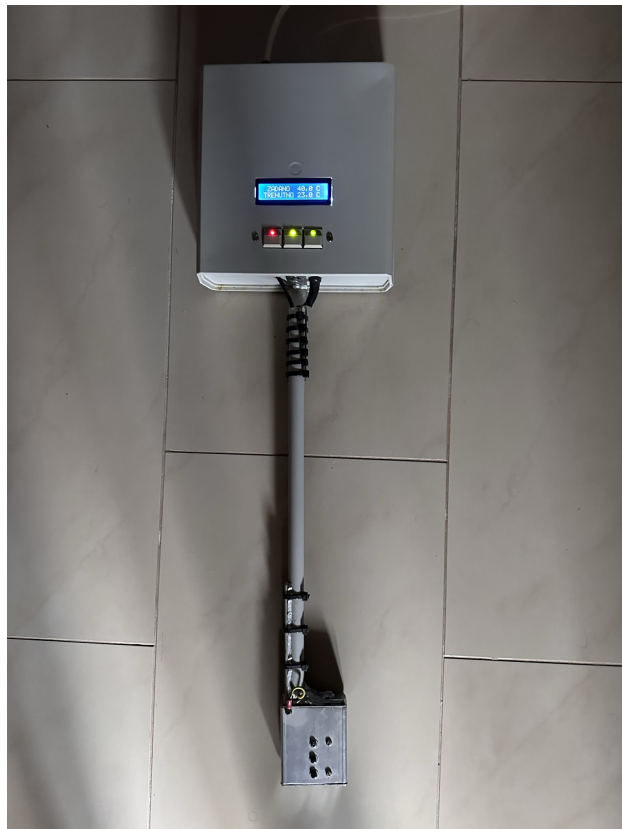
Slika 1.1: Regulator viskoznosti meda
