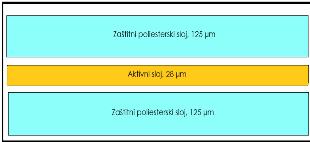
Slika 3.2: Shematski prikaz poprečnog presjeka GafChromic EBT3 filma.
