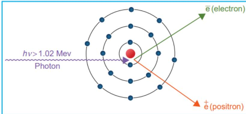
Slika 2.5: Shematski prikaz tvorbe para elektron-pozitron [8].
