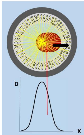
Slika 5.7: Shematski prikaz skeniranja profila doze u nereferentnoj geometriji.
