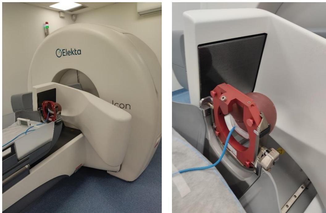
Slika 5.8: Leksellov gama nož sa ionizacijskom komorom i fantomom Solid Water, CBCT skener se nalazi u spuštenom položaju (lijevo), fiksirani fantom i ionizacijska komora (desno).
