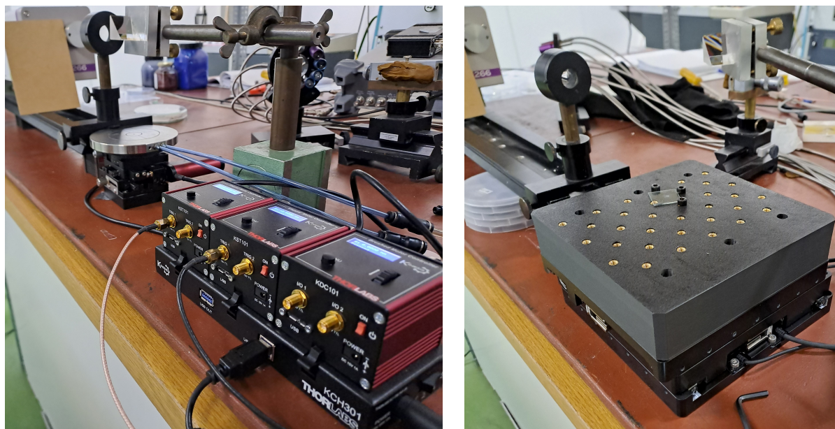
Slika 5.9: Lijevo: Thorlabs pomično postolje s koračnim motorima i mikrokontrolerima. Desno: Newport pomično postolje na koje smo postavili 3D isprintan pokrov kako bi mogli fiksirati uzorke i zaštititi postolje.
