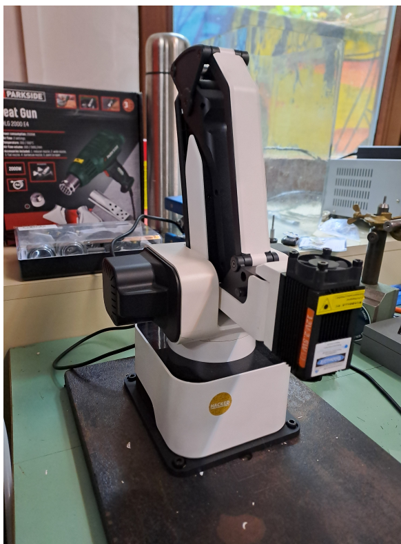
Slika 5.8: Korištena robotska ruka s pričvršćenim kontinuiranim laserom.
