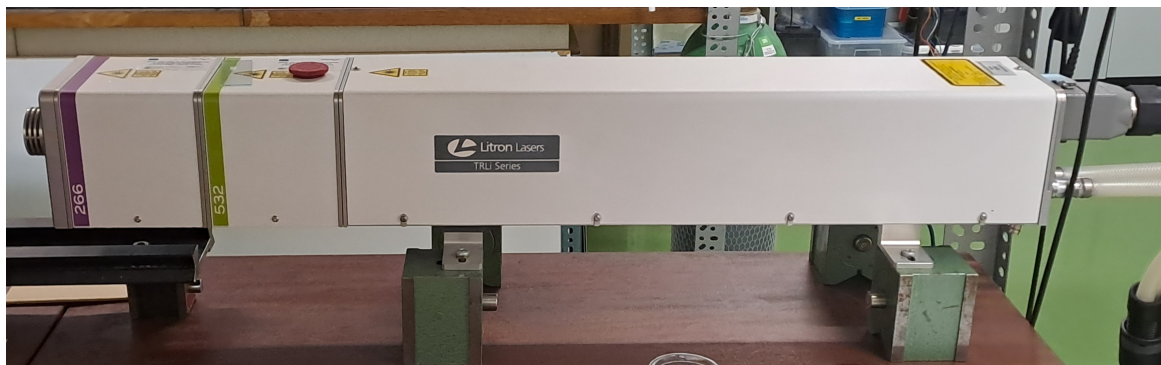
Slika 5.2: Korišteni Litron nanosekundni pulsni laser na koji su spojena dva harmonička modula.
