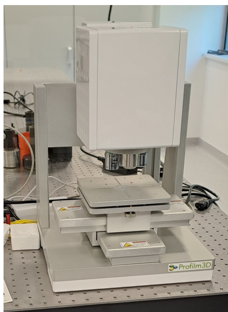
Slika 5.11: Lijevo: Filmetrics Profilm 3D profilometar koji smo koristili. Desno: Shema optičkog profilometra s Mirau objektivom. Preuzeto s izvora [45] i prilagođeno.
