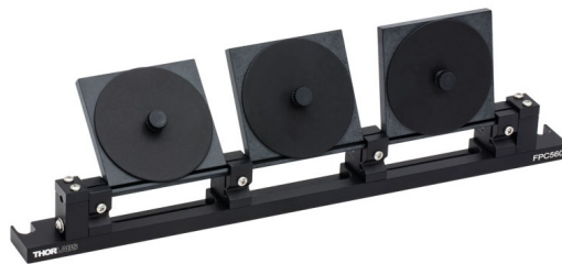
Slika 3.7: Polarizacijski kontroler proizvođača Thorlabs, model FPC560. Izvor: [10]
