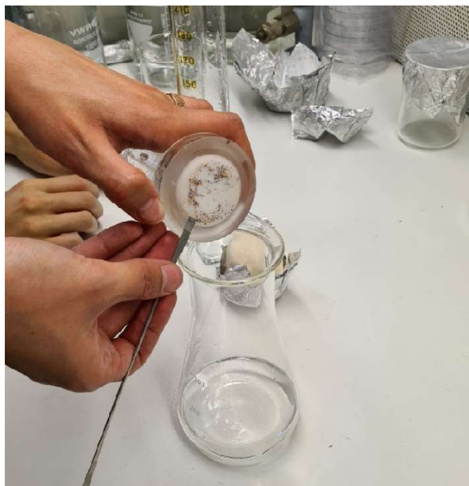
Slika 2. Prebacivanje filter papira sa onečišćenim mikročesticama plastike i gume u tikvicu s hranjivom podlogom (Izvor: E. Kokić).
