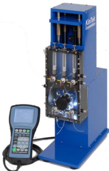
Slika 3.5: Instrument s mogućnošću brzog zaustavljanja reakcije (engl. Rapid Chemical Quench ).
