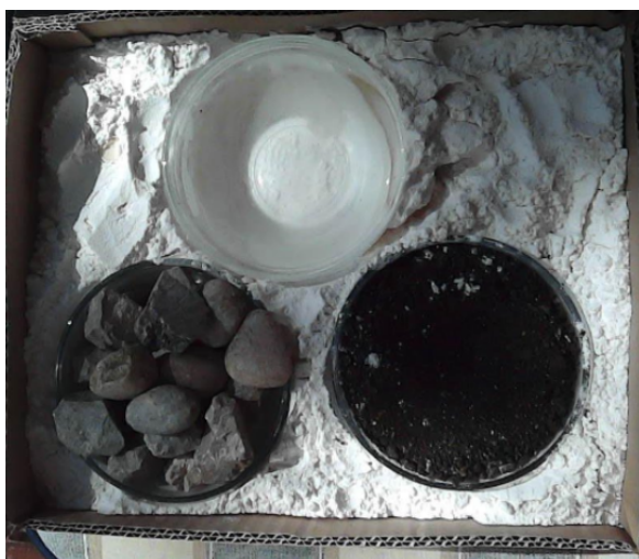
Slika 4.1: Postav pokusa: Zagrijavanje jednako osvjetljenih površina
