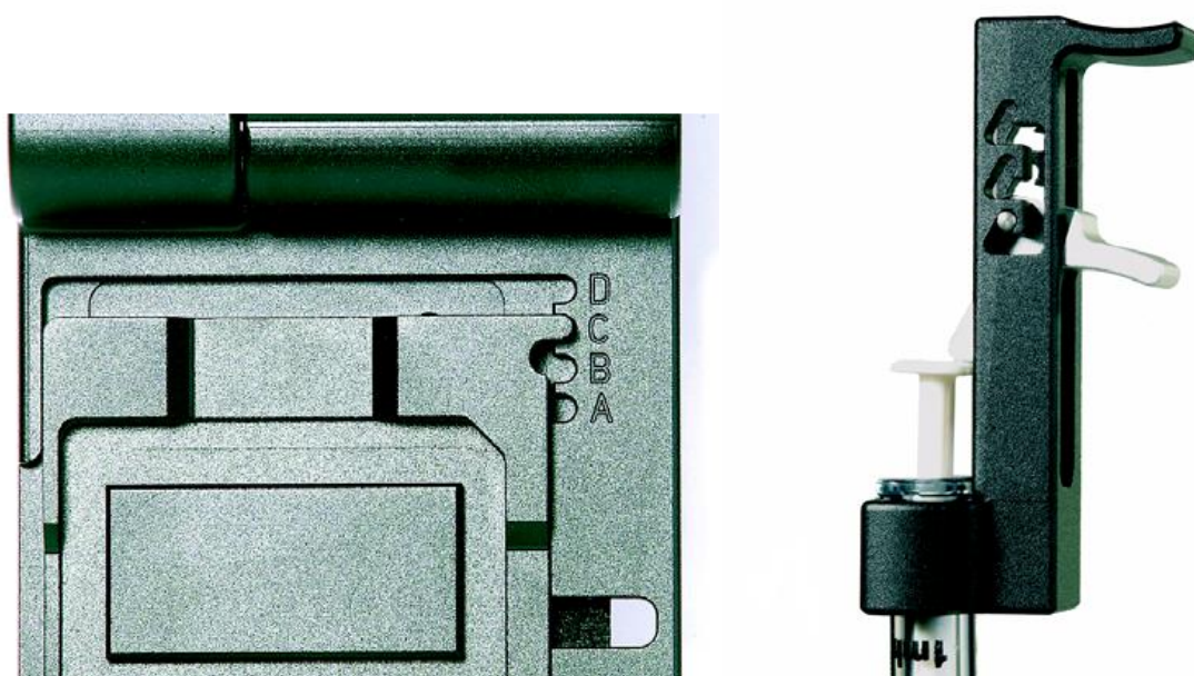
Slika 28. Bazna ploča nosača za nanašanje uzoraka i poluga klipa (prilagođeno prema 272 )
