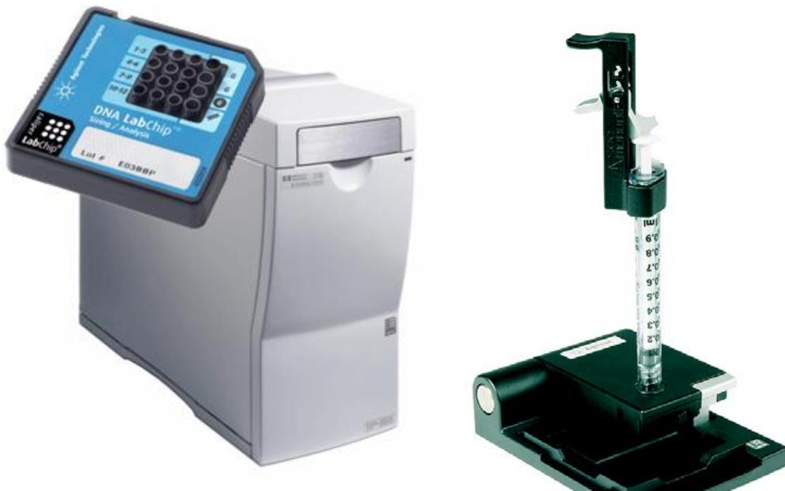
Slika 29. Agilent DNA 1000 čip, bioanalizator i postolje za pripravu čipa (prilagođeno prema <sup>273)</sup>
