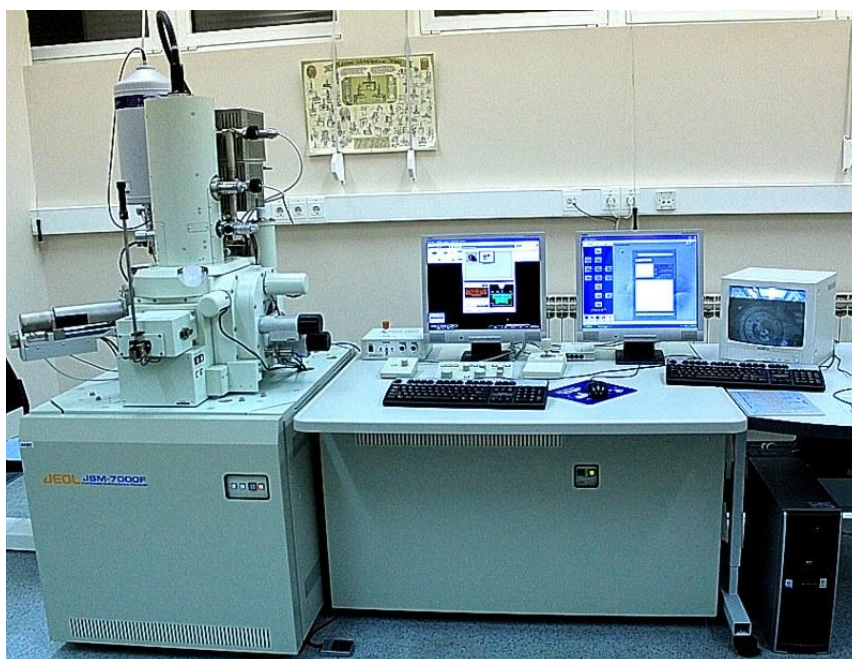
Slika 4.4. Pretražni elektronski mikroskop JEOL JSM-7000F
