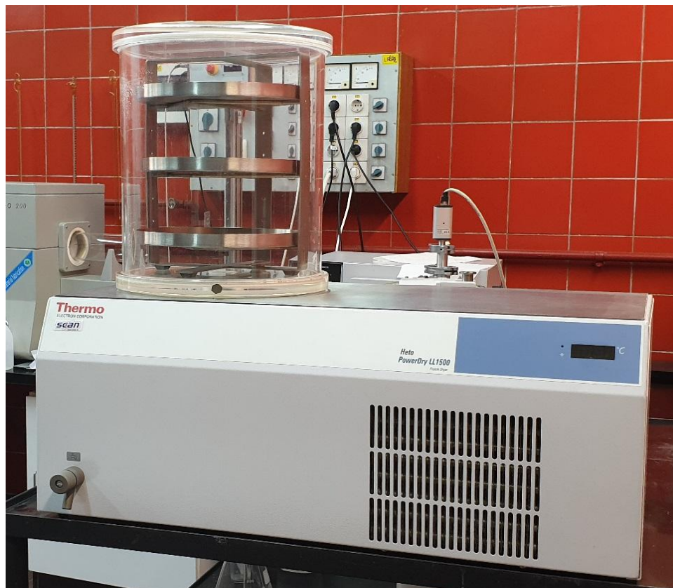
Slika 4.2. Liofilizator, HETO PowerDry LL1500
