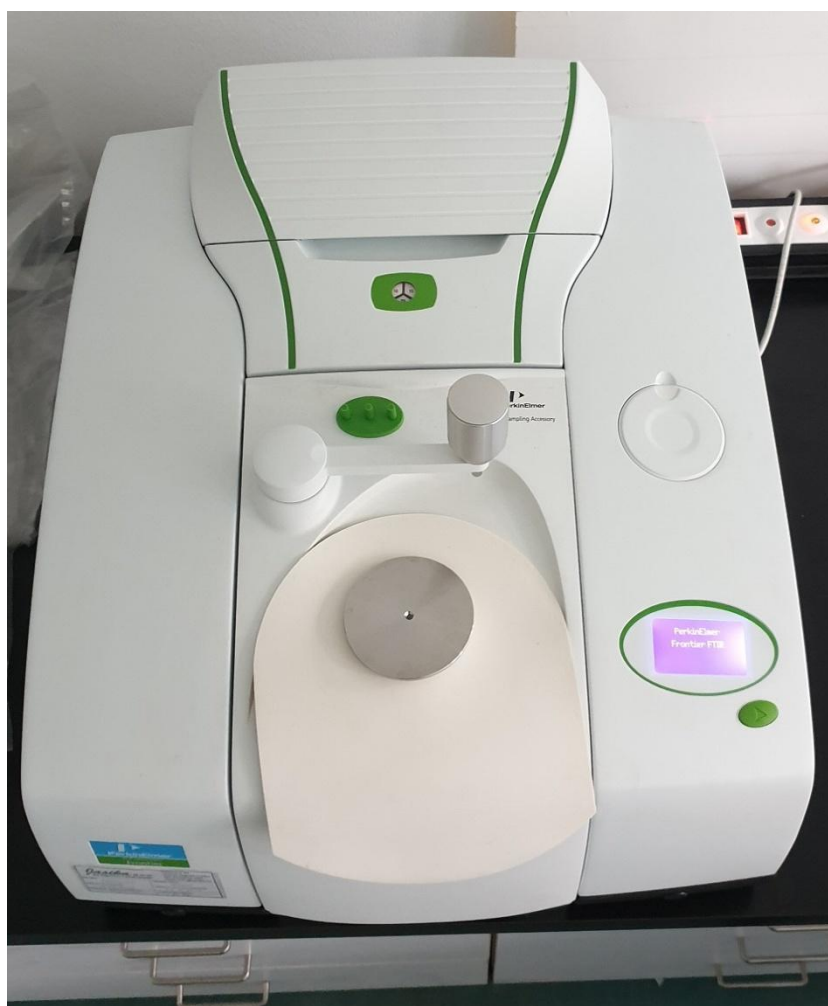
Slika 4.7. FT-IR infracrveni spektrometar, Perkin Elmer Frontier, s dijamantnim ATR dodatkom
