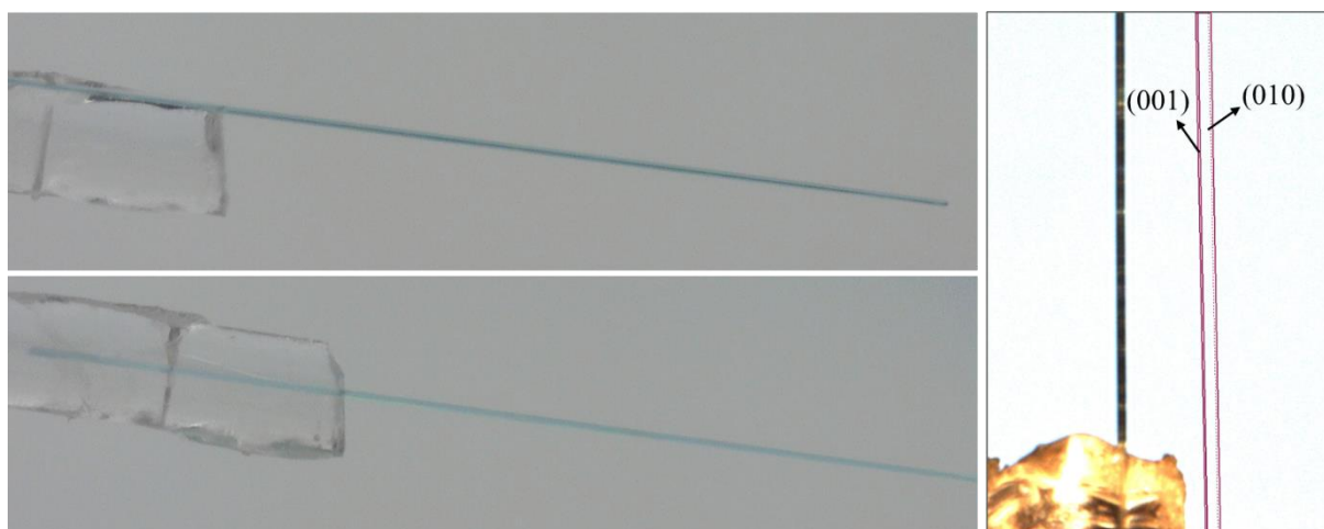
Slika 49. Igličasti kristal spoja Cu1 priređen za difrakcijske pokuse određivanja pripadajućih Millerovih indeksa dominantnih kristalnih ploha. Fotografije snimljene u programu DinoCapture 17 pri povećanju od pedeset puta. Kristal je od početne orijentacije ( lijevo gore ) zarotiran za 90° ( lijevo dolje ). Određeni Millerovi indeksi pripadni dominantno razvijenim kristalnim plohama za igličasti kristal spoja Cu1 ( desno ).
