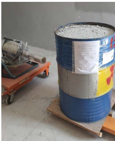
Slika 17. Gama-spektrometrijsko mjerenje bačvi prijenosnim detektorskim sustavom
