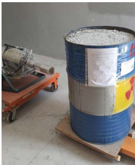
Slika 17. Gama-spektrometrijsko mjerenje bačvi prijenosnim detektorskim sustavom
