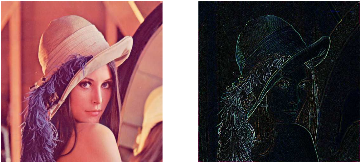
Slika 4.2: Prikaz učitane slike Lena na lijevoj strani te rezultata konvolucije s jezgrom za detekciju ruba na desnoj strani
