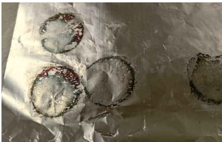
Slika M3. Produkti nastali na aluminijskoj foliji kroz neko vrijeme nakon provedene elektrolize.
