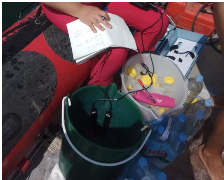
Slika 10. Mjerenje fizikalno-kemijskih čimbenika vode i koncentracije klorofila a neposredno pri uzorkovanju.
