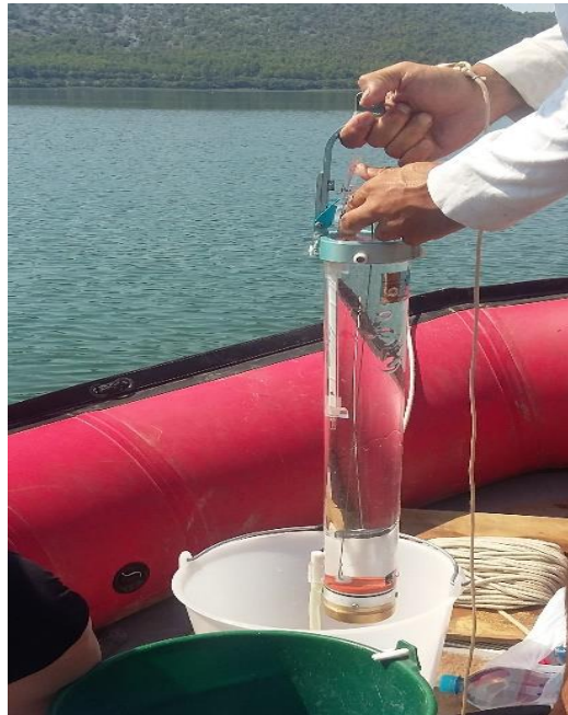
Slika 9. Dubinski uzorkivač ili crpac zapremine pet litara (Hydro-Bios Apparatebau GmbH, Njemačka) za uzorkovanje fitoplanktona.
