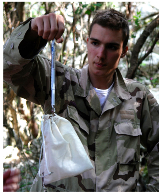
Slika 12. Mjerenje mase opružnom vagom
