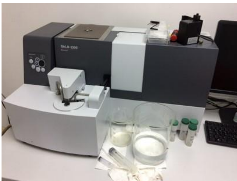
Slika 4.9. Laserski difraktometar Shimadzu Laser Diffraction Particle Size Analyzer SALD-2300 Hrvatskog geološkog instituta korišten za određivanje veličine zrna, njihove raspodjele i zastupljenosti u materijalima jezgre Koločepskog kanala.
