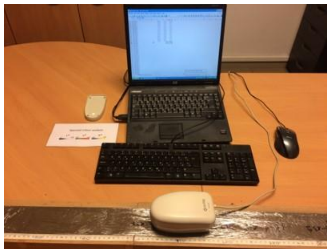
Slika 4.6. Ručni spektrofotometar X-Rite DTP22/Digital Swatchbook Hrvatskog geološkog instituta korišten za mjerenje spektralne boje izbušenih jezgri u Koločepskom kanalu.
