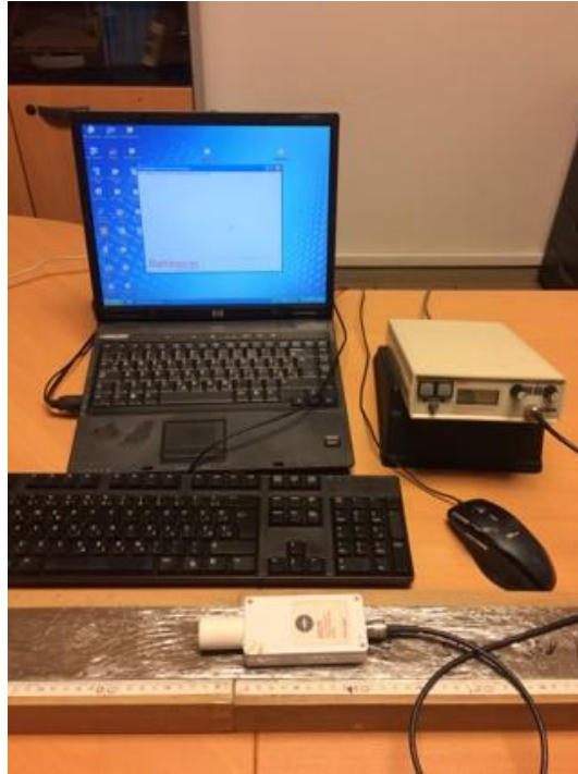
Slika 4.8. Ručni uređaj Bartington MS2 s pratećim programom Multisus Hrvatskog geološkog instituta korišten za mjerenje magnetskog susceptibiliteta izbušenih jezgri u Koločepskom kanalu.
