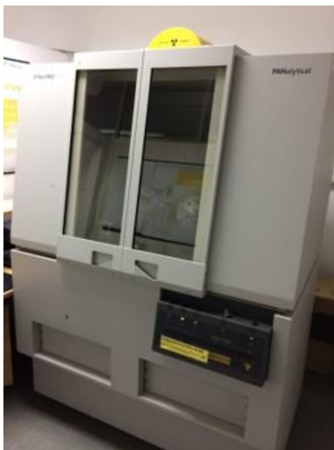
Slika 4.10. Rendgenski difraktometar PANalytical X'Pert Powder Hrvatskog geološkog instituta korišten za analizu mineraloškog sastava metodom rendgenske difrakcije na prahu na uzorcima Koločepskog kanala.
