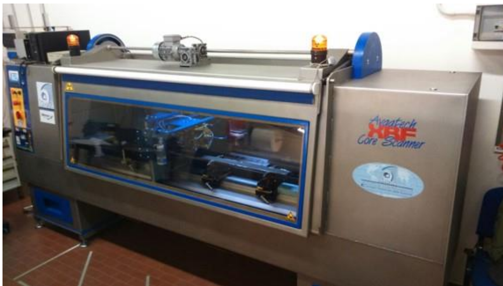
Slika 4.11. Avaatech XRF Core Scanner Instituta za znanost o moru (CNR-ISMAR) u Bologni korišten za analizu kemijskog sastava sedimenata Koločepskog kanala.
