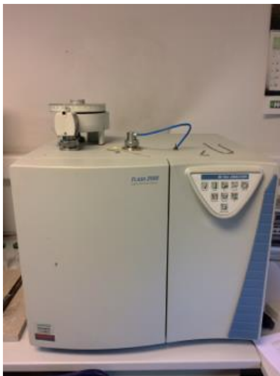
Slika 4.12. CN analizator za tla i sedimente Thermo Fischer Scientific, Flash 2000 NC Analyzer Hrvatskog geološkog instituta korišten za analizu organskog i anorganskog ugljika i ukupnog dušika na uzorcima jezgara Koločepskog kanala.
