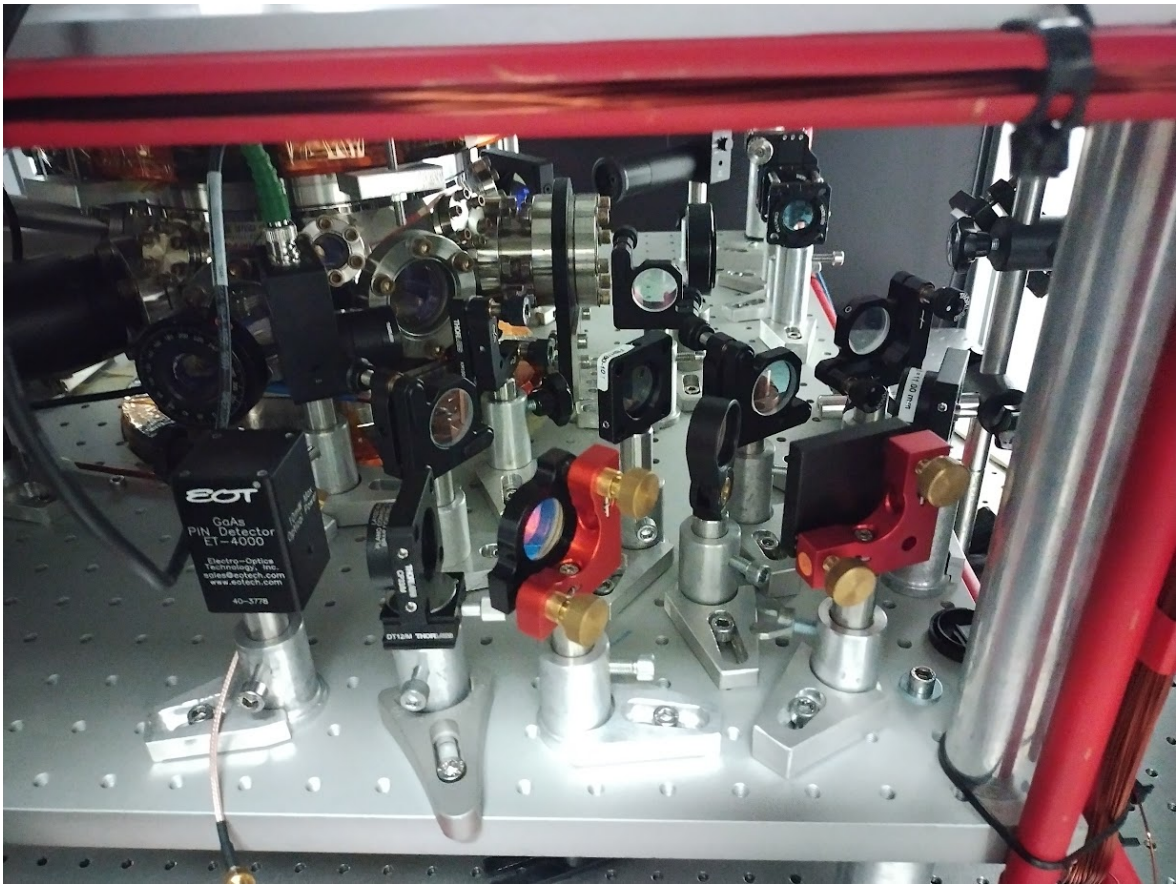
Slika 3.9: Fotografija postava za mjerenje udara.
