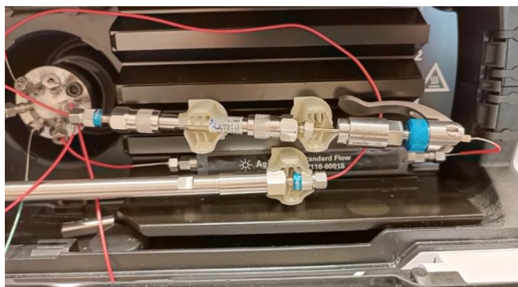
Slika 12. C-18 kolona i pripadajući nosač s pretkolonom spojeni na uređaj za tekućinsku kromatografiju.
