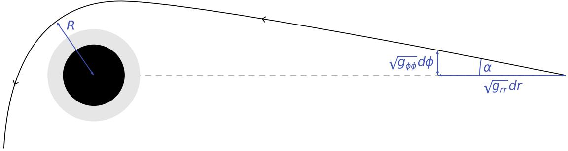
Slika 3.1: Primjer svjetlosne zrake emitirane od opažača pod kutom  $\alpha$  prema Schwarzschildovoj crnoj rupi. Zraka prolazi kraj crne rupe na minimalnoj radikalnoj koordinati  $R$  (periastronu), koja se može povezati s kutom  $\alpha$  poznajući svojstva odgovarajućeg geodezika svjetlosnog tipa. Istaknuti su horizont događaja (crni krug) i fotonska sfera (sivi vijenac) crne rupe. Prilagođeno iz [5, 7].
