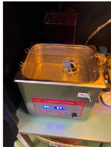
Slika 3.28: Ultrazvučno čišćenje wafera
