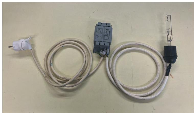
Slika 2.21: Balast spojen u strujni krug s UV žaruljom
