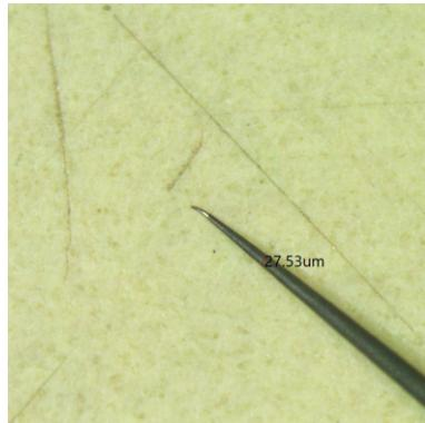
Slika 3.45: Šiljasti vrh voframove žice dobiven paljenjem žice na plameniku
