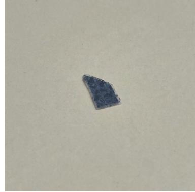
Slika 2.13: Scotch traka s tankim slojevima Bi-2212 kristala na silicijskom waferu
