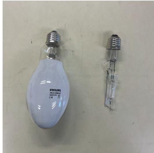
Slika 2.20: UV žarulja prije i nakon skidanja vanjskog staklenog sloja
