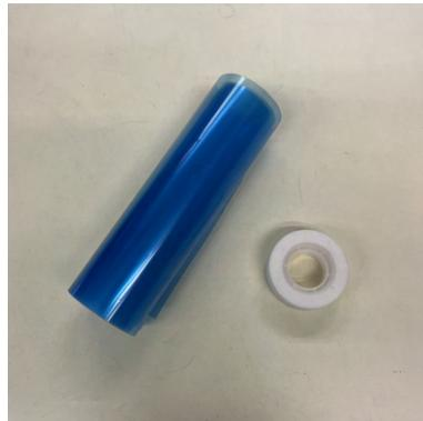
Slika 2.10: Ljepljiva traka osjetljiva na ultraljubičastu svjetlost (lijevo) i 3M Scotch ljepljiva traka (desno) korištene u eksperimentu
