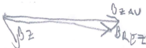
Slika 39. Crtež učenika C5 u kojem prikazuje rezultatno magnetsko polje B_{REZ} koje djeluje na iglu kompasa i koje se sastoji od magnetskog polja zavojnice B_{ZAV} i magnetskog polja Zemlje B_Z .
