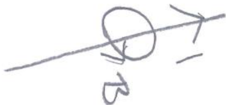
Slika 29. Crtež učenice D3 u kojem prikazuje smjer magnetskog polja B u odnosu na smjer struje I u ravnom vodiču.
