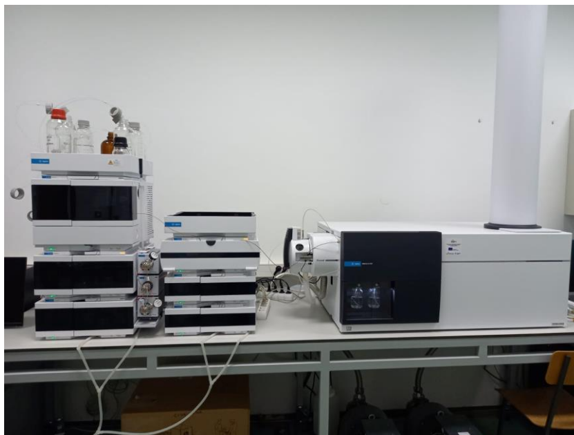
Slika 5. Instrument Agilent 6550 Series Accurate-Mass-Quadrupole Time-of-flight (Q-TOF) uz direktno uvođenje uzoraka pomoću Agilent 1290 Infinity II UHPLC sustava uz elektroraspršenje kao ionizacijski izvor korišten za analizu uzoraka
