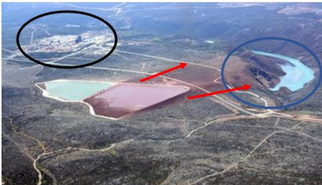
Slika 1. Smjer širenja crvenog mulja (označen crvenim strelicama) iz otpadnih bazena tvornice Jadral (označena crnom elipsom) prema rijeci Zrmanji (označena plavom elipsom) (izvor: Bezik, 2019).
