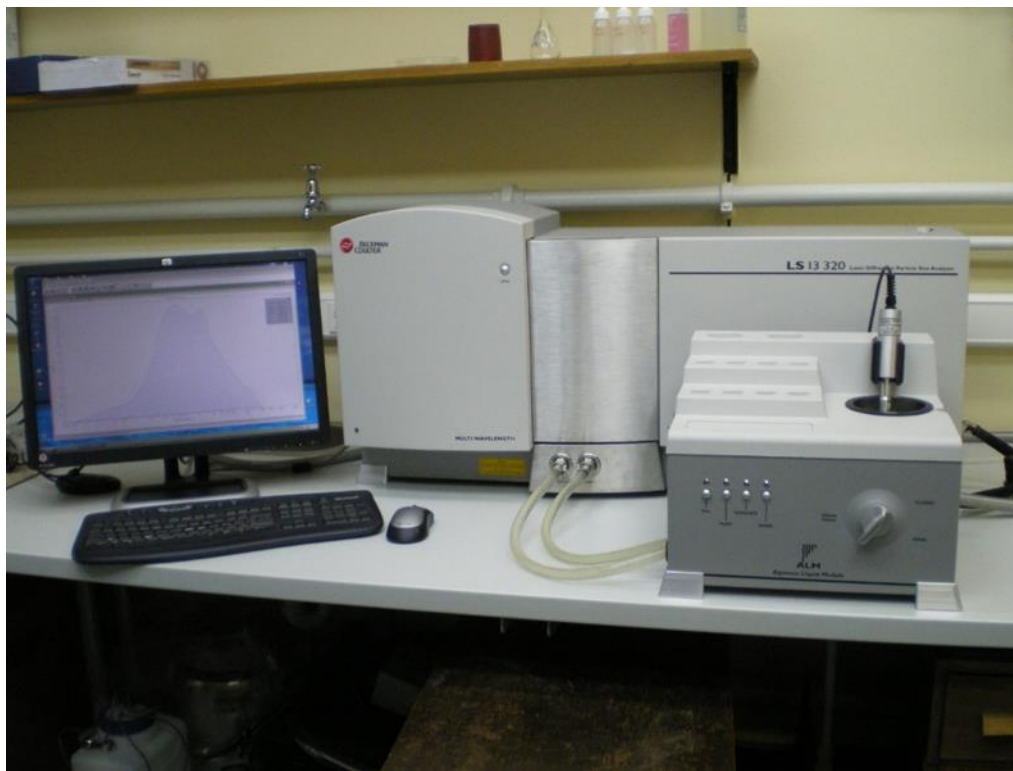
Slika 8. Instrument za granulometrijsku analizu LS 13 320 (Beckman Coulter, SAD).
