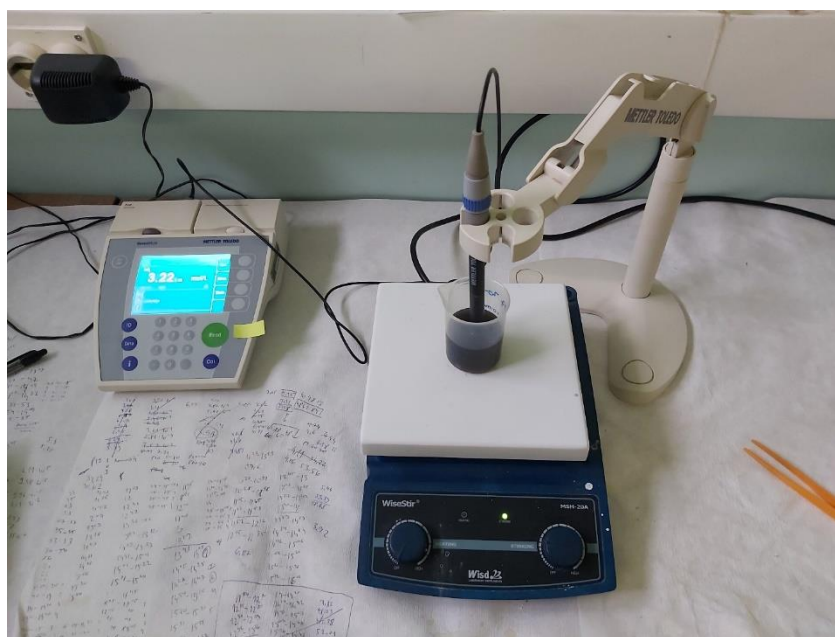
Slika 9. Mjerenje kapaciteta kationske izmjene amonij selektivnom elektrodom (Mettler Toledo, Švicarska).
