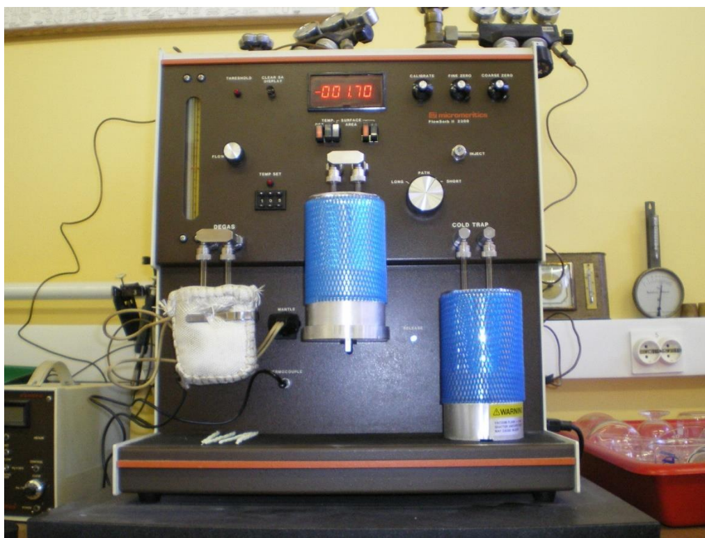
Slika 10. Instrument za određivanje specifične površine FlowSorb II 2300 (Micromeritics, SAD).
