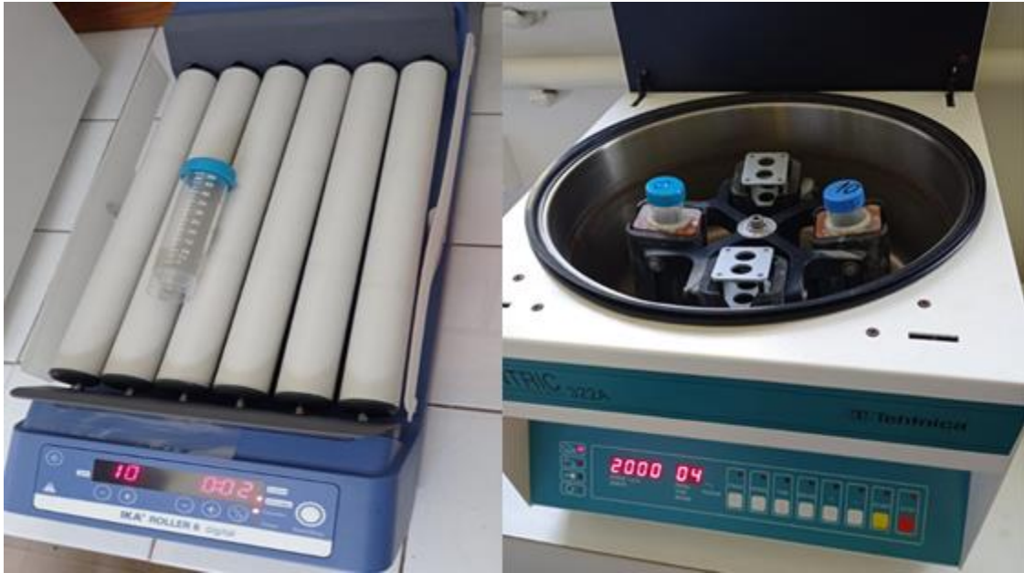
Slika 7. Retorta s uzorkom postavljena na miješalici na brzini trešnje 100 i centrifugiranje na 2000 okretaja u minuti ( Izvor: vlastite fotografije)
