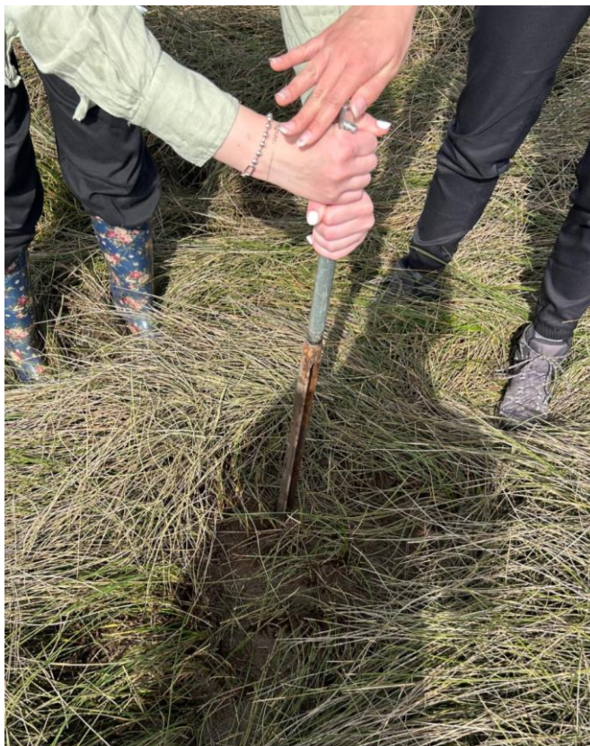
Slika 4. Prikupljanje jezgre SM1 korištenjem ručnog jezgrila marke Ejikelkamp
