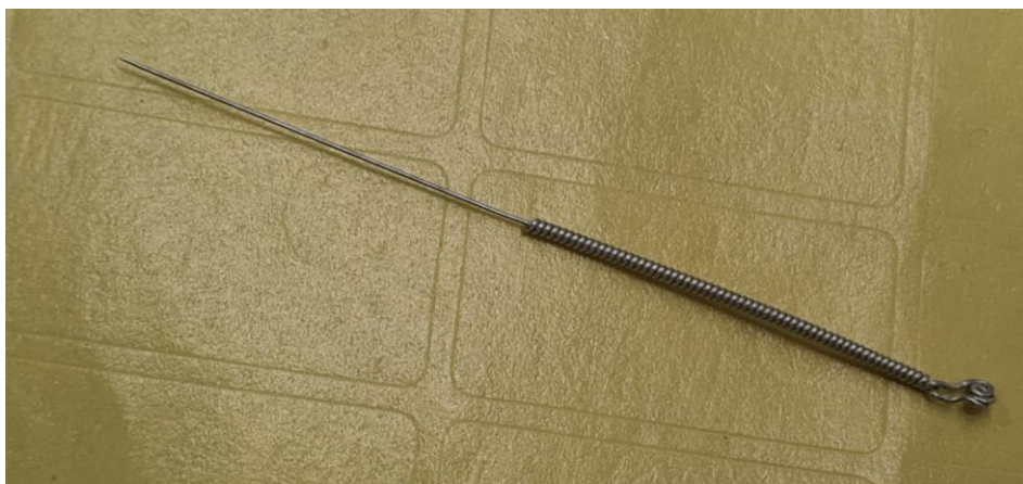
Slika 8: Iglica za akupunkturu korištena prilikom pripreme listića tinjaca.
