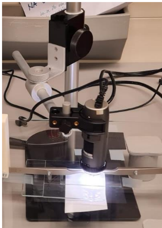
Slika 12: Korištena Dino-Lite digitalna kamera.
