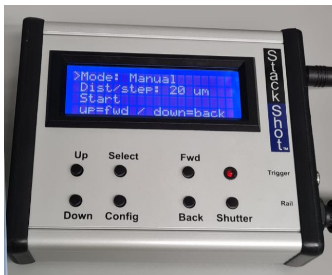
Slika 10: Elektromotor kojim se kontrolira pomak 26 pincete prema uzorku s korakom od 20 \mu\text{m} .
