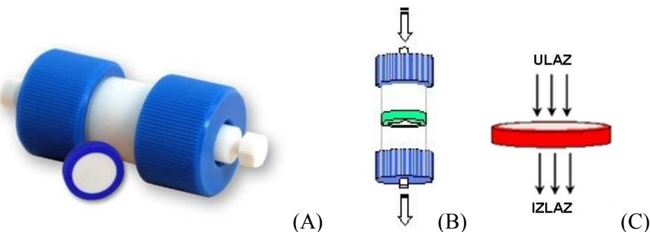
**Slika 14.** (A) CIM-disk i pripadajuće kućište; (B) i (C) Smjer toka mobilne faze.
