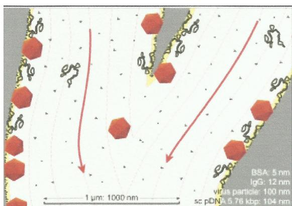
**Slika 13.** Tok mobilne faze kroz pore monolitnog nosača. Siva područja označavaju materijal monolita, bijela područja označavaju prostor pore, a crvene strelice označavaju laminarno strujanje. Preuzeto s: <http://www.validated.com/revalbio/pdffiles/London.pdf>
