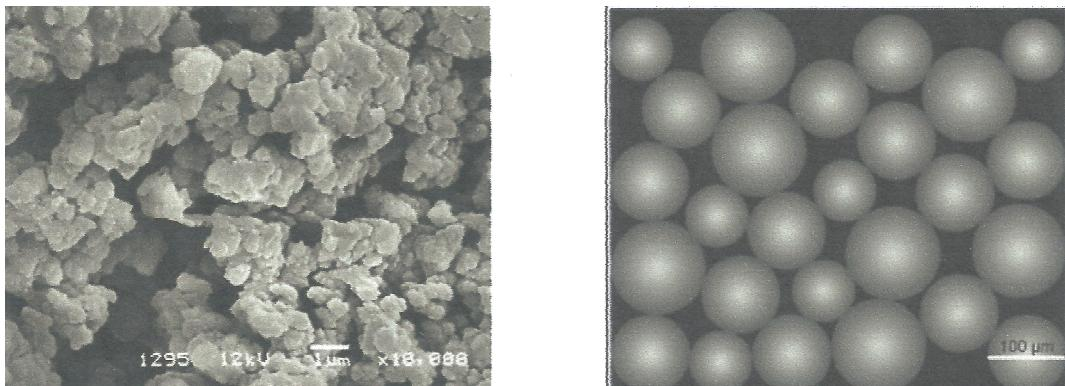
**Slika 12.** Usporedba monolitnog nosača (lijevo) i nosača s kuglicama (desno).
