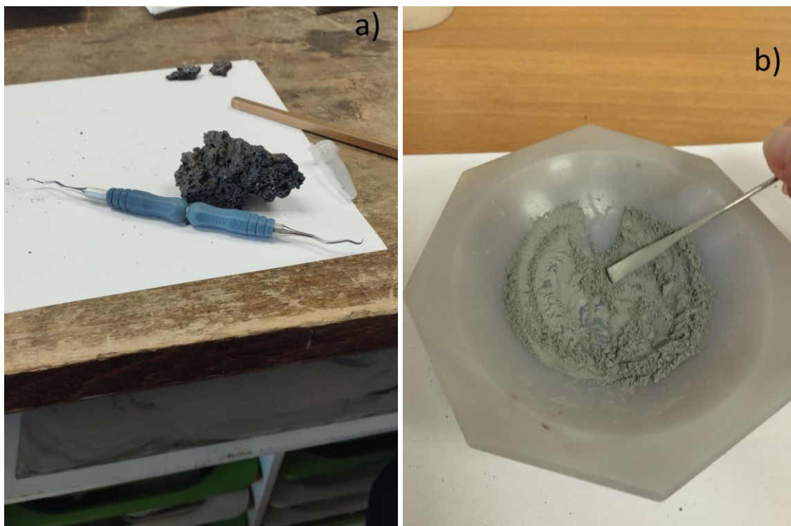
Slike (7) - a) Odvajanje fenokristala iz uzoraka, b) Priprema preparata za rendgensku difrakcijsku analizu
