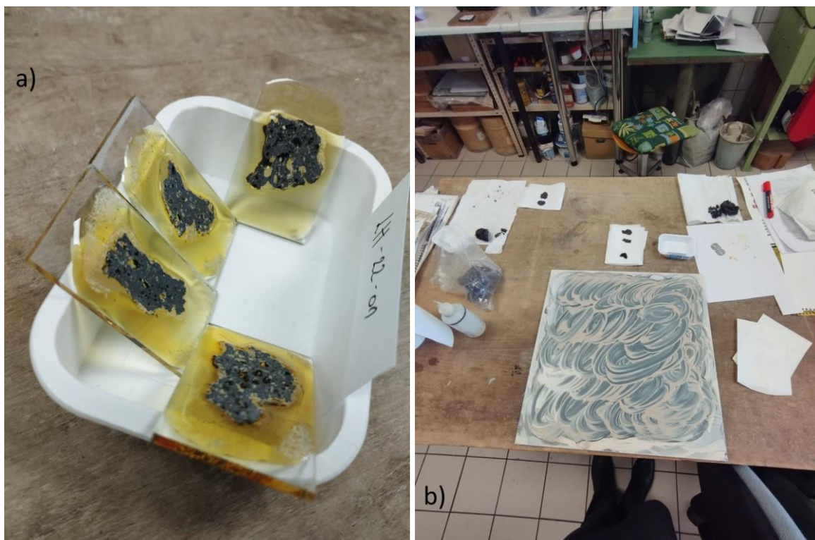
Slika (6) – a) Mikroskopski preparati pričvršćeni za predmetno stakalce prije brušenja, b) Izrada preparata na staklenoj ploči s brusnim prahom
