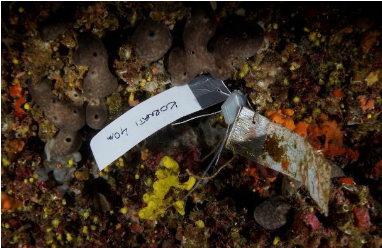
Slika 19. Mjerač podataka za mjerenje temperature i količine svjetlosti na postaji Mana (NP Kornati).
