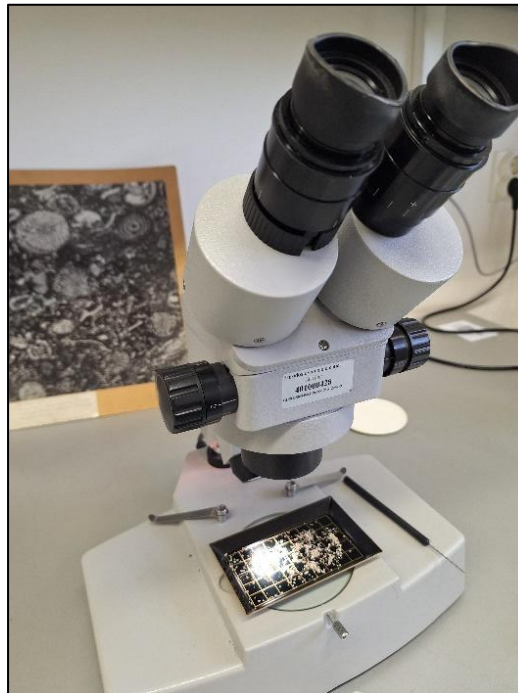
Slika 12. Stereoskopski mikroskop, plitica i iglica za mikroskopiranje
