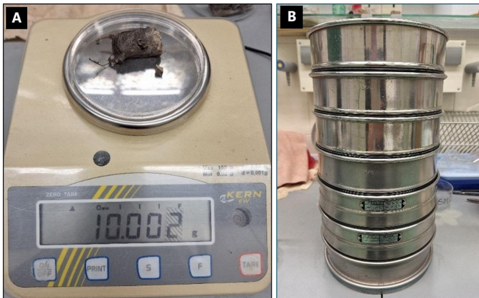
Slika 8. a) vaganje osušenih uzoraka b) sita sa sedam različitih promjera otvora
