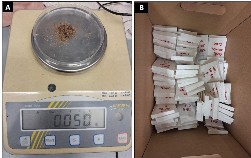
Slika 10. a) vaganje svake frakcije nakon sušenja b) materijal pohranjen u vrećicama
