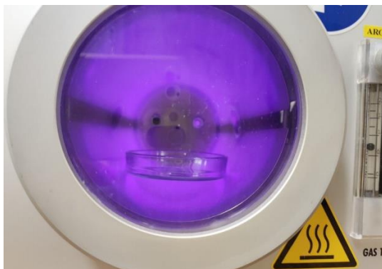
Slika 13. Petrijeva zdjelica s uzorcima u komori za plazmu, nakon što je pušten dovod kisika.
