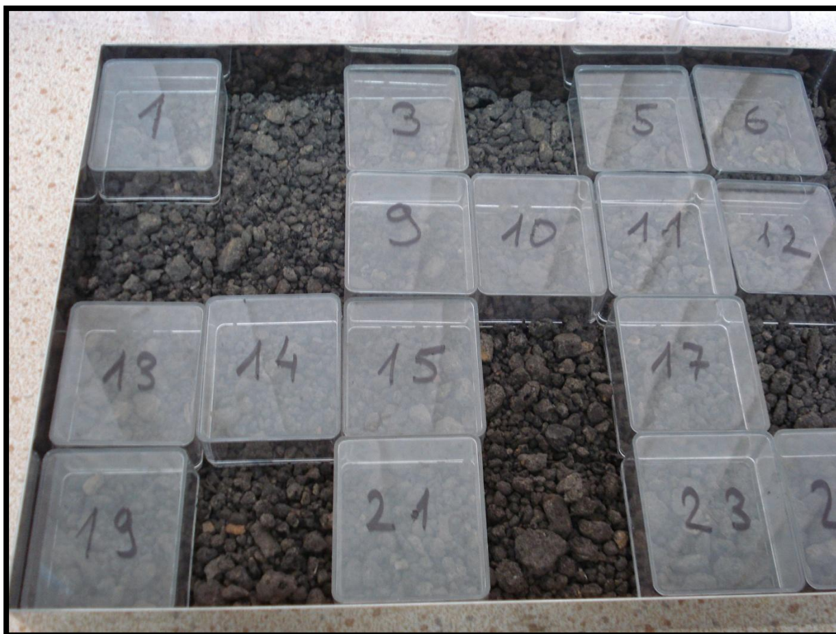
Slika 16. Ravnomjerno raspoređen cjelokupni uzorak iz kojeg će se determinirati 1/3 sadržaja
