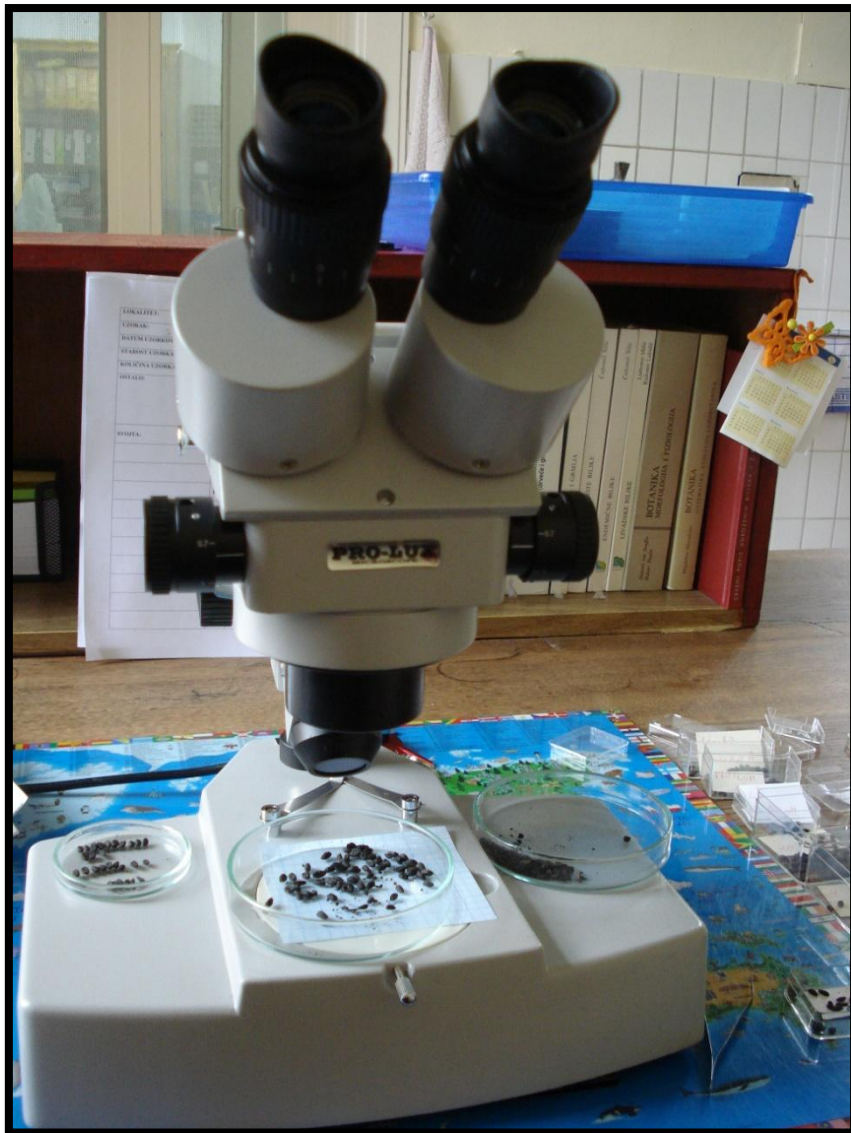
Slika 17. Binokularna lupa uz pomoć koje je odrađena izolacija i determinacija biljnih ostataka
