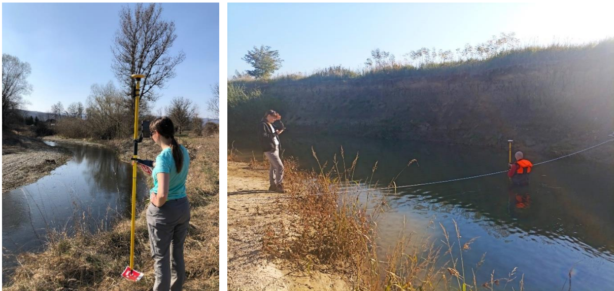
Sl. 3.14. Prikupljanje točaka za terensku kontrolu (lijevo), mjerenje poprečnog profila korita (desno)
